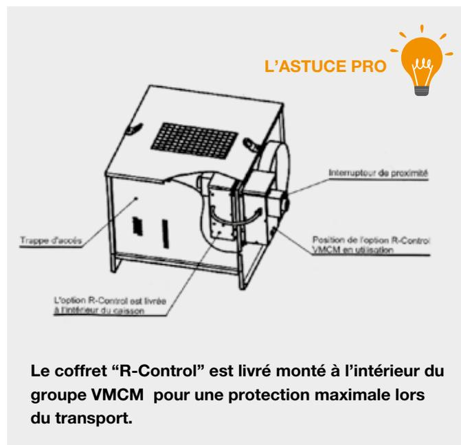
Le coffret "R-Control" est livré monté à l'intérieur du groupe VMCM pour une protection maximale lors du transport.
