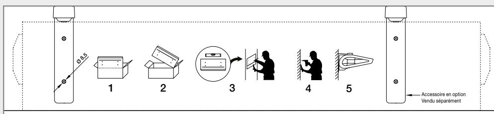
Chaque emballage de rideau d'air WING2 intègre un guide de montage taille réelle indiquant l'emplacement et les diamètres des perçages à effectuer.
