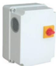
Les coffrets LOBBY™ se présentent sous la forme de coffrets IP54 équipés d'un régulateur électronique, d'un capteur de pression avec intégrateur et transmetteur de signal et d'un interrupteur de proximité cadenassable. Ils permettent, grâce à leur fonction variation de vitesse, une mise en conformité avec la directive ErP.
