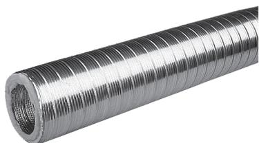
Principalement utilisée dans les installations de VMC et de traitement d'air, la gaine FORM permet de pallier aux risques de condensation (VMC simple flux) et de maintenir la température de l'air (VMC double flux et traitement d'air) lors de son cheminement dans le réseau de ventilation.
