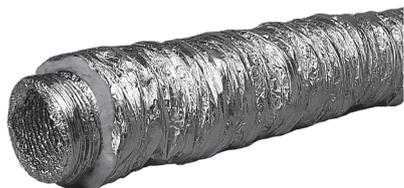
Principalement utilisée dans les installations de VMC et de traitement d'air, la gaine SONO permet de pallier aux risques de condensation (VMC simple flux) et de maintenir la température de l'air (VMC double flux et traitement d'air) lors de son cheminement dans le réseau de ventilation.
