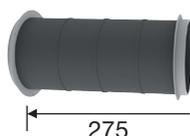
**Manchette à joint de traversée de dalle Ø 125** est indispensable au raccordement de la bouche sur le conduit. Elle est intégrée et scellée dans la dalle ou se fixe après coup par 3 vis.
