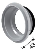
**Manchette à joint Ø 125** est indispensable au raccordement de la bouche sur le conduit. Son joint assure une parfaite étanchéité. Elle se fixe sur la paroi par 3 vis.
