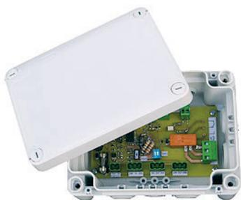
Ce boîtier permet de convertir différents types de signaux d'entrée issus des sondes CO<sub>2</sub> ou des capteurs de présence en un signal de sortie compatible avec la commande des moteurs des registres ou des ventilateurs.
