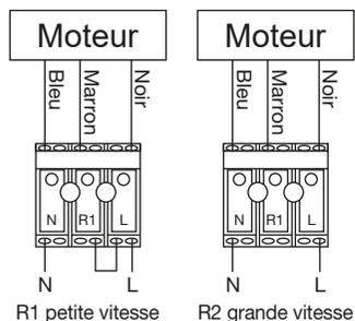
A l'aide d'un tournevis, déverrouillez la trappe du boîtier de connexion électrique en faisant levier, réalisez le raccordement électrique et refermez le boîtier de connexion. Le circuit d'alimentation électrique doit comporter un dispositif de protection conforme à la norme NF C 15-100.
