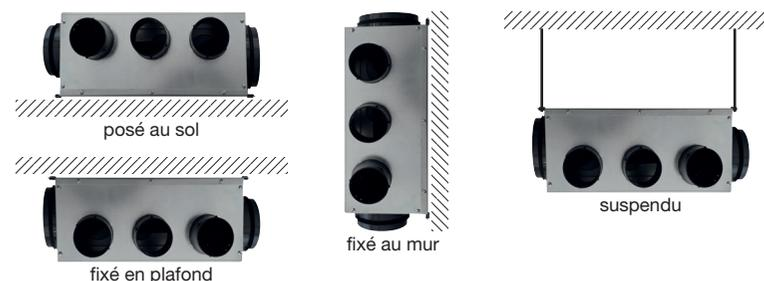
Fixé à un mur ou un plafond au moyen de 4 vis (non fournies) ou suspendu au moyen de tige filetée Ø8 mm max (sans les plots).
