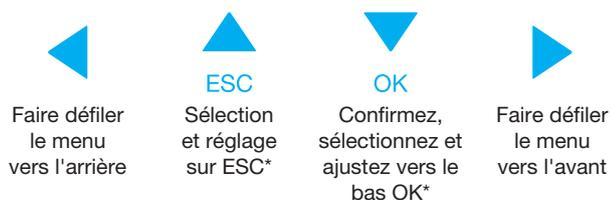
\*Les fonctions ESC et OK s'activent en les maintenant enfoncées pendant environ une seconde
