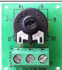
**Régler la molette sur la position « V » désirée**, suivant la direction de la flèche. Cette position correspond à une courbe du caisson (voir caractéristiques aérauliques) afin d'adapter le point de fonctionnement du caisson au besoin de votre installation.
