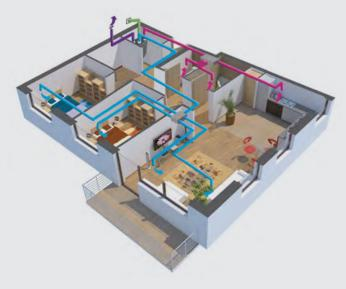
En ventilation double-flux, votre air neuf tempéré et filtré est introduit au moyen des bouches de soufflage desservies par la centrale double-flux. Par rapport à une VMC simple flux, vous disposez donc d'un second réseau dit de "soufflage".
