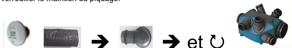
Les bouches d'extraction sanitaires équipées de manchettes Ø80 et la bouche cuisine Ø 125 installées dans les pièces correspondantes seront raccordées aux piquages de raccordement de l'Infinity avec de la gaine de même diamètre que celui de la bouche. Il est conseillé d'utiliser de la gaine isolée afin d'éviter tout phénomène de condensation à l'intérieur des gaines de ventilation.
