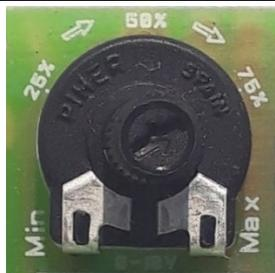
**Régler la molette sur la position % désirée**, suivant la direction de la flèche. Cette position correspond à une courbe du caisson (voir caractéristiques aérauliques) afin d'adapter le point de fonctionnement du caisson au besoin de votre installation.
