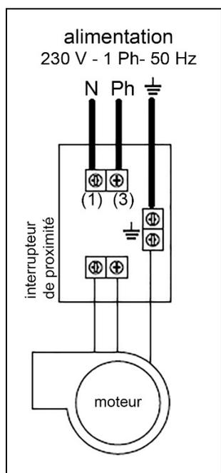
**Nos appareils sont livrés pré-câblés jusqu'à l'interrupteur de proximité.**
