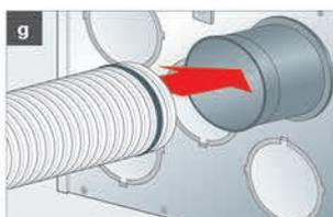
Mettre le joint sur le conduit
