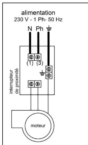
**Nos appareils sont livrés pré-câblés jusqu'à l'interrupteur de proximité.**
