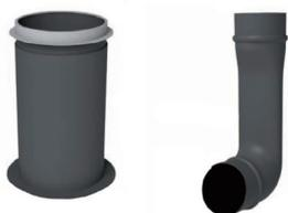
Les bouches plastiques ESA 80 - ECU 125 sont utilisées uniquement en extraction pour la ventilation en habitat individuel. Les bouches  $\varnothing$  80 mm sont implantées en sanitaires et les bouches  $\varnothing$  125 en cuisine. Ces bouches sont le plus souvent associées à des groupes de vmc simple flux ou double flux autorégulés (débits calibrés directement sur les groupes de vmc ou sur des répartiteurs spécifiques).
