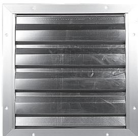
Les volets de surpression permettent de maintenir une surpression ou une dépression dans un local par rapport à l'extérieur ou un autre local au moyen de leurs vantelles anti-retour qui s'ouvriront uniquement dans le sens du flux d'air souhaité sous une certaine différence de pression.
